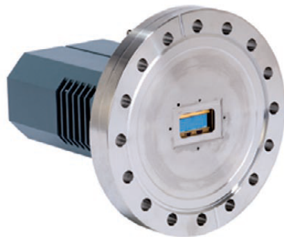
Abbildung 3.9.: CCD-Kamera der Firma Andor, Typ DO420 BR-DD mit einer Matrix von 1024 x 255 Pixel. Die Kamera wird unter Vakuum betrieben und über einen CF100-Flansch angeschlossen [59].
