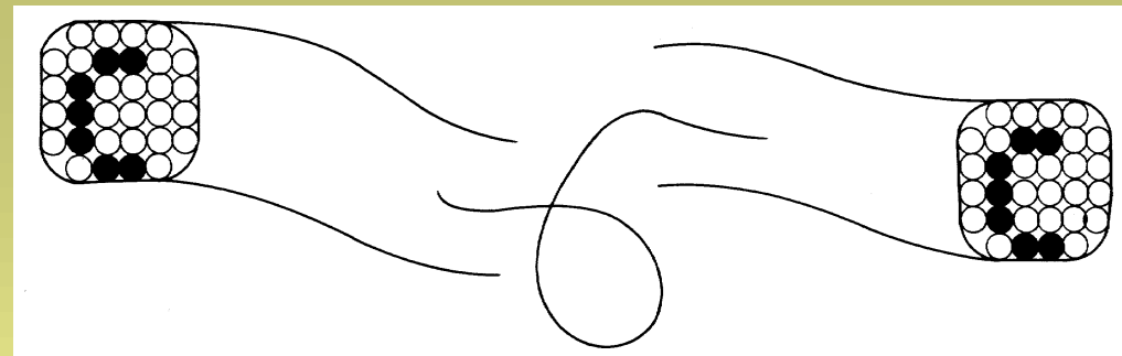
geordnetes Lichtleiterbündel zur Bildübertragung
