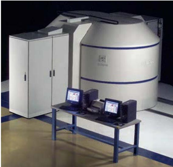
Zyklotron zur Isotopenerzeugung
