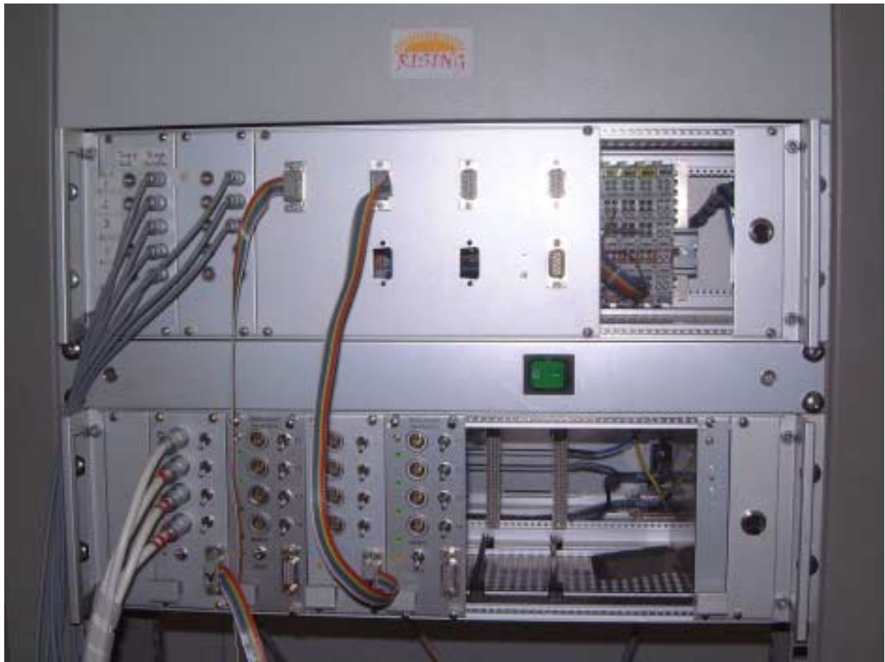
Abbildung 22: Fotografie der Elektronik einer Steuereinheit. Im oberen 19-Zoll Einschub befindet sich die Elektronik von der Firma Beckhoff und im Einschub unten die Relaiskarten [HS02].
