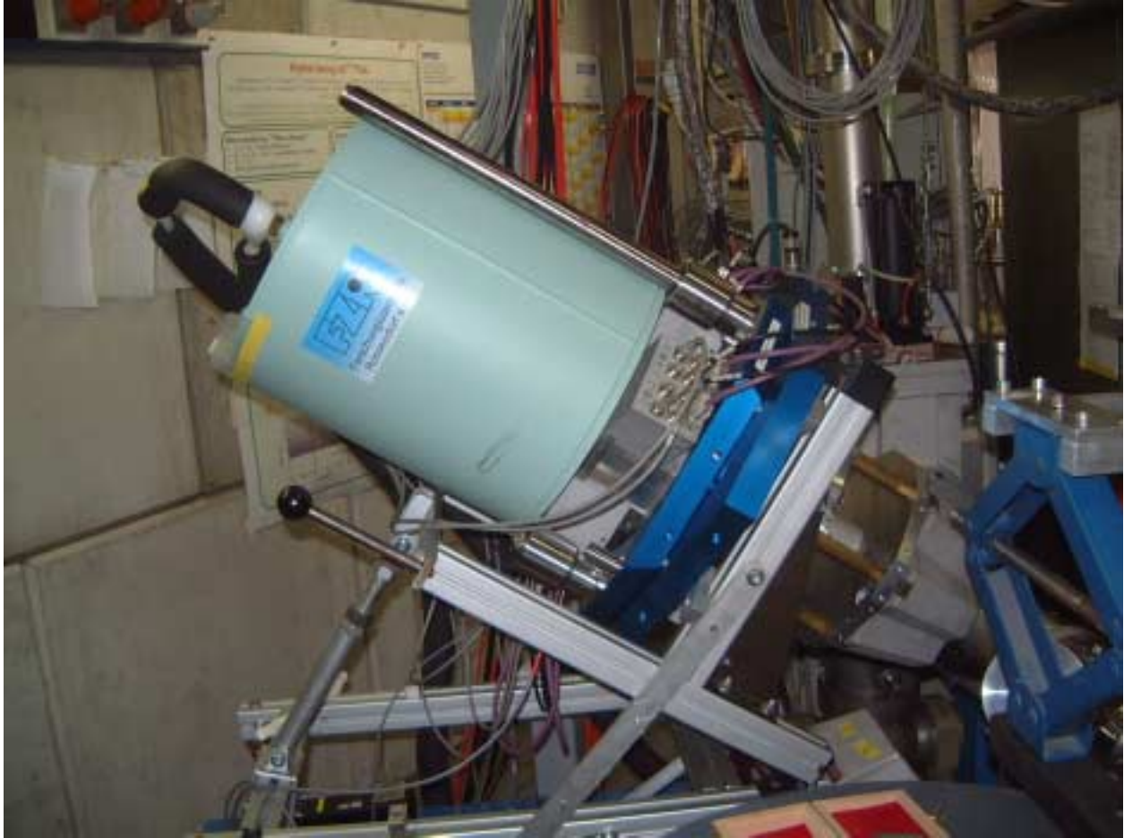
Abbildung 20: Seitenansicht des Germanium – Detektors: rechts der Detektorkopf mit seinen 7 Kristallen, dahinter die Vorverstärker und im hinteren Bereich der Kühltank.
