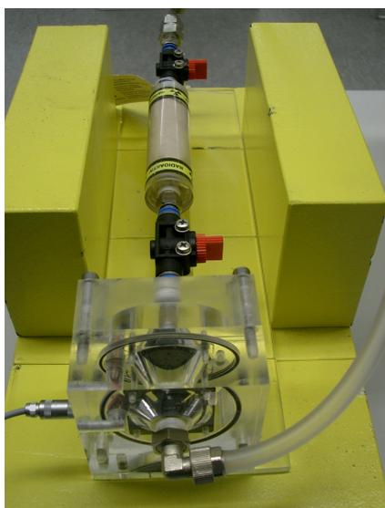
Im linken Bild sieht man (nach Entfernung der beiden oberen Bleiziegel) den Zylinder mit dem Thoriumsals und dem Ventilator im Vordergrund. Die von dem Thoriumsals ausgehende  $\gamma$ -Strahlung wird von den umgebenden 5 cm dicken Bleiziegeln hinreichend abgeschirmt.
