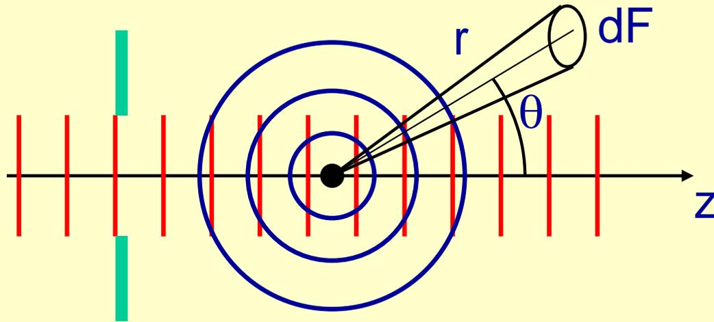
$$\Psi(r) = A \left[ e^{ikz} + f(\vartheta) \frac{1}{r} e^{ikr} \right] \quad \text{Streu-Wellenfunktion}$$
